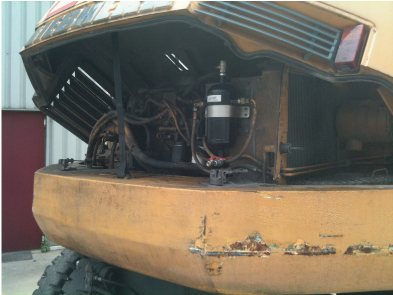
De microseparator heeft een licht centrifugale werking, waardoor eerst het water en vervolgens de vaste bestanddelen uit de diesel gehaald worden.
