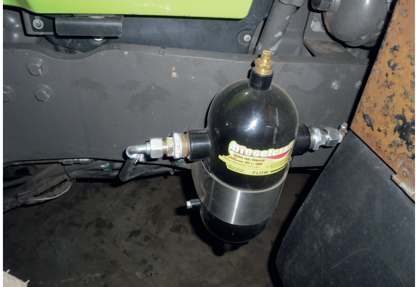
Een model 5x12 microseparator, gemonteerd op een tractor. Tractoren hebben vrij veel last van brandstofproblemen, doordat er een kunststof tank wordt gebruikt.
