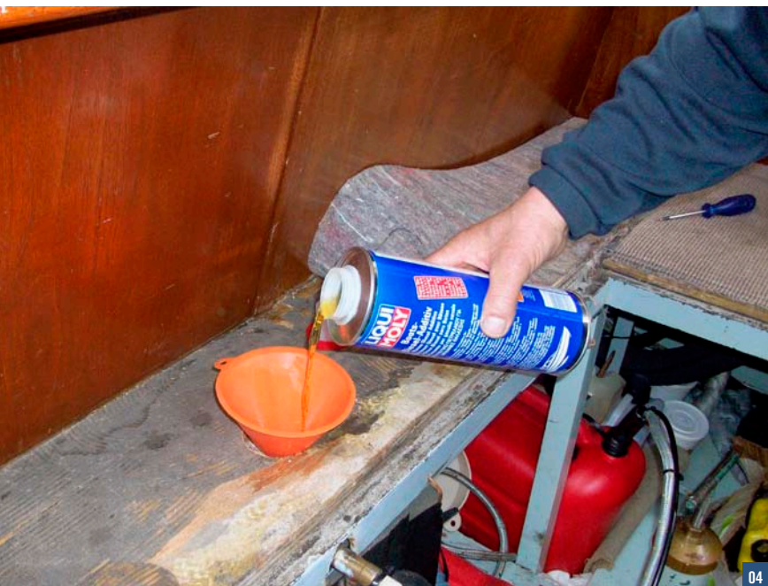
04 De Liqui Moly wordt in de tank gegoten. Preventief wordt 1:1000 aanbevolen, bij een geïnfecteerde tankinhoud 1:200.
