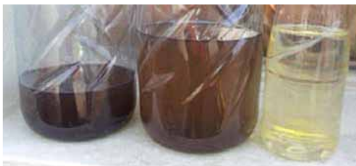
Hierboven van links naar rechts: 2 monsters van vervuilde diesel en de derde: schone diesel terug de tank in.
