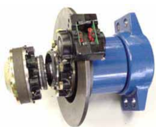
P501-W met remschijf opgebouwd tussen het stuwdrukklager en de homokinetische aandrijfas.
