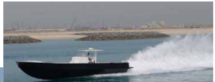
hierboven en hiernaast: Black Thunder (Dubai 48') 14,6 mtr. met 2 x 720 pk. Gewicht 9,4 ton. Topsnelheid 56 kn.
